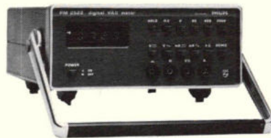
Afb. 6 PM2522: DMM met LED meetwaardepresentator en gepatenteerde analoog \rightarrow digitaal omzetting; de nauwkeurigheid wordt „voor het leven” gegarandeerd.
